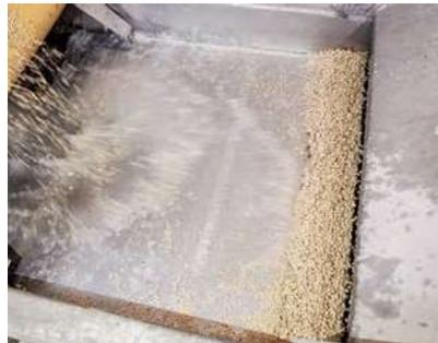
Diese synthetischen Kork Partikel werden weiter zu feinem Granulat verarbeitet. Dies geschieht durch Extrudieren (Pressen) des Materials.
