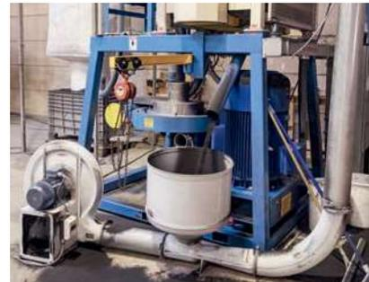
Zum Schluss wird das Granulat mit dem Pulver vom natürlichen Kork zusammengefügt und noch einmal gemahlen. Anschliessend können die Töpfe produziert werden.
